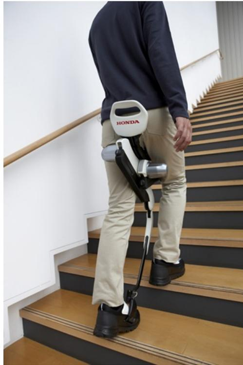
Figura 3.6: Um exoesqueleto combina um sistema de controle humano com músculos robóticos, podendo auxiliar pessoas com problemas motores e ainda no âmbito militar possibilitando soldados carregarem cargas excessivas de peso.
