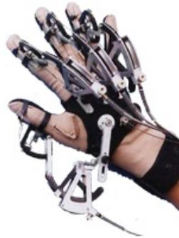
Figura 3.3: Luva com sensação de *force-feedback*. Exoesqueleto que nos permite sentir os objetos em ambientes virtuais, sendo que simula a consistência e textura dos diversos materiais.
