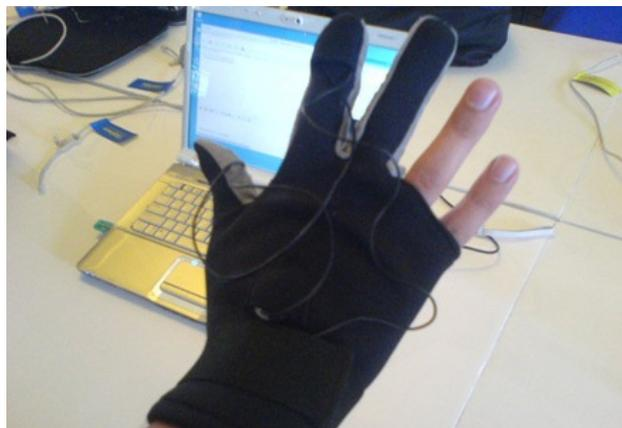
Figura 3.4: Apresenta uma luva com sensação de *force-feedback*.
