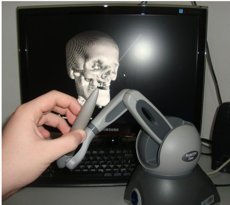
Figura 7.1: Phantom Omni em interação com malha háptica.
